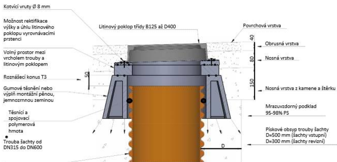
Obr. 1.25. Úprava zakončení plastových šachet
